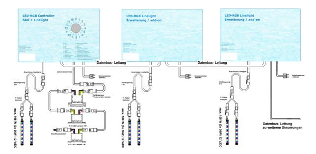
Die Erweiterungsmodule verfügen jeweils über einen Ausgang für Linelights mit max. 108W 12 V/DC.
